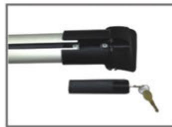
Чтобы получить доступ к болтам регулировки ширины упоров и прижимному болту нижней части крепления, следует снять заглушку, расположенную вверху. Для этого необходимо вложить ключ в замок, повернуть его в вертикальное положение, а затем потянуть к себе, снимая заглушку с крепежного элемента.
