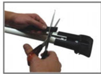
В случае, если прокладка посередине слишком длинна, в результате чего невозможно докрутить болт регулировки ширины адаптера, следует ее укоротить с помощью ножниц таким образом, чтобы показалась головка болта, однако длина прокладки должна быть такой, чтобы хоть частично накладка закрывала ее. Чрезмерное укорачивание прокладки приведет к появлению свиста во время езды.
