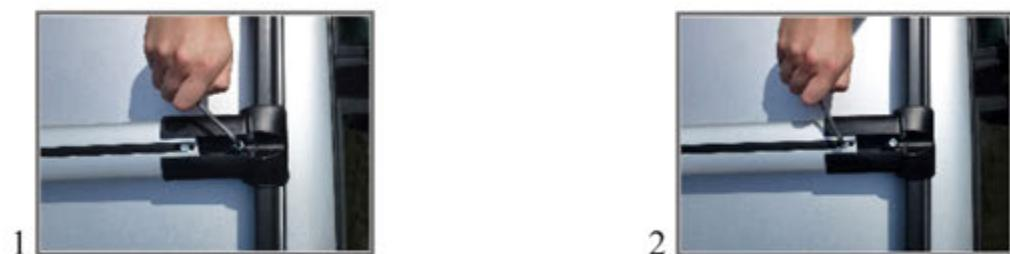
Когда багажник размещен на рейлингах правильным образом, закрутить болт крепления (фото 1) и болт регулировки ширины адаптера (фото 2) с помощью шестигранного ключа, входящего в состав комплекта, с силой 4 Н·м.
