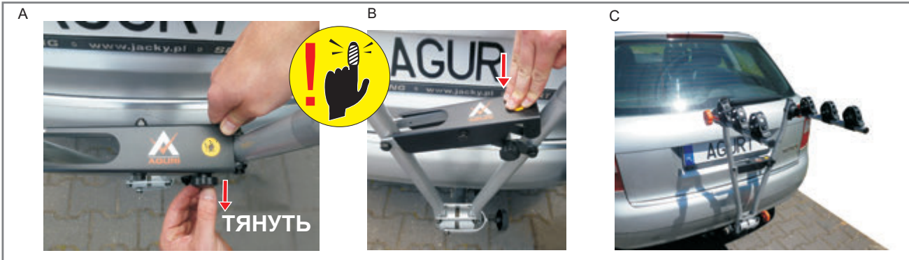
Рис. 6 Потяните замок перекладины, находящийся между держателями рам (рис. 6 А) и нажмите перекладину, выравнивая ее (рис. 6 В). ВНИМАНИЕ! БУДЬТЕ ОСОБЕННО ОСТОРОЖНЫ ВО ВРЕМЯ РАСКРЫТИЯ ДЕРЖАТЕЛЕЙ РАМ И НАЖАТИЯ ПЕРЕКЛАДИНЫ!
